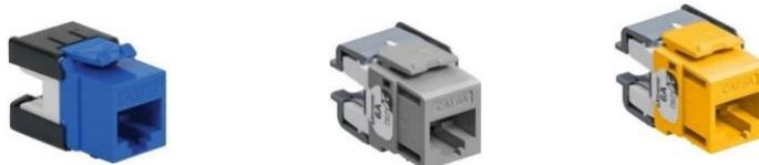
Deberán cumplir o exceder las especificaciones y requisitos de la norma para componentes ANSI / TIA-568.2-D para conectar hardware de 1 MHz a 500 MHz mínimo. Que sea instalado como parte de una solución completa de cableado estructurado que soporte velocidades de transmisión de hasta 1 Gbps para pruebas de enlace canal permanente. Azul para datos, gris para voz, amarillo o cualquier otro color para cámaras de CCTV.
